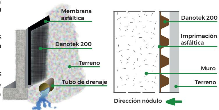
**Espesor de la lámina: 4mm**
